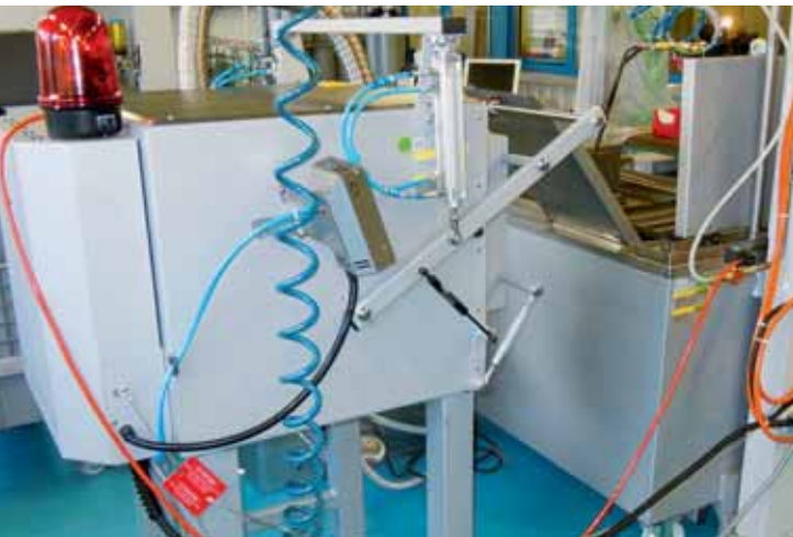
Instalación de temple que permite la realización de pequeñas series de pinzas de forma racional.
