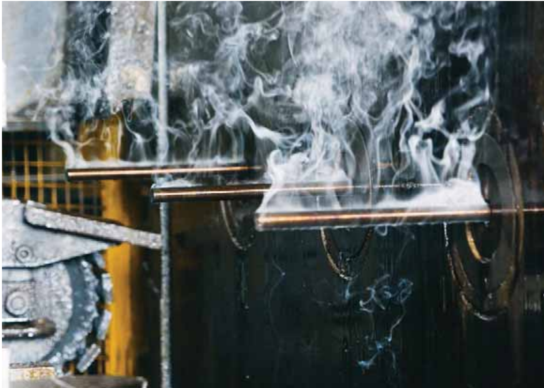
该公司改变特种钢的机械性能和工艺性能的方法之一，就是在拉制过程中通过设置参数来实现。
