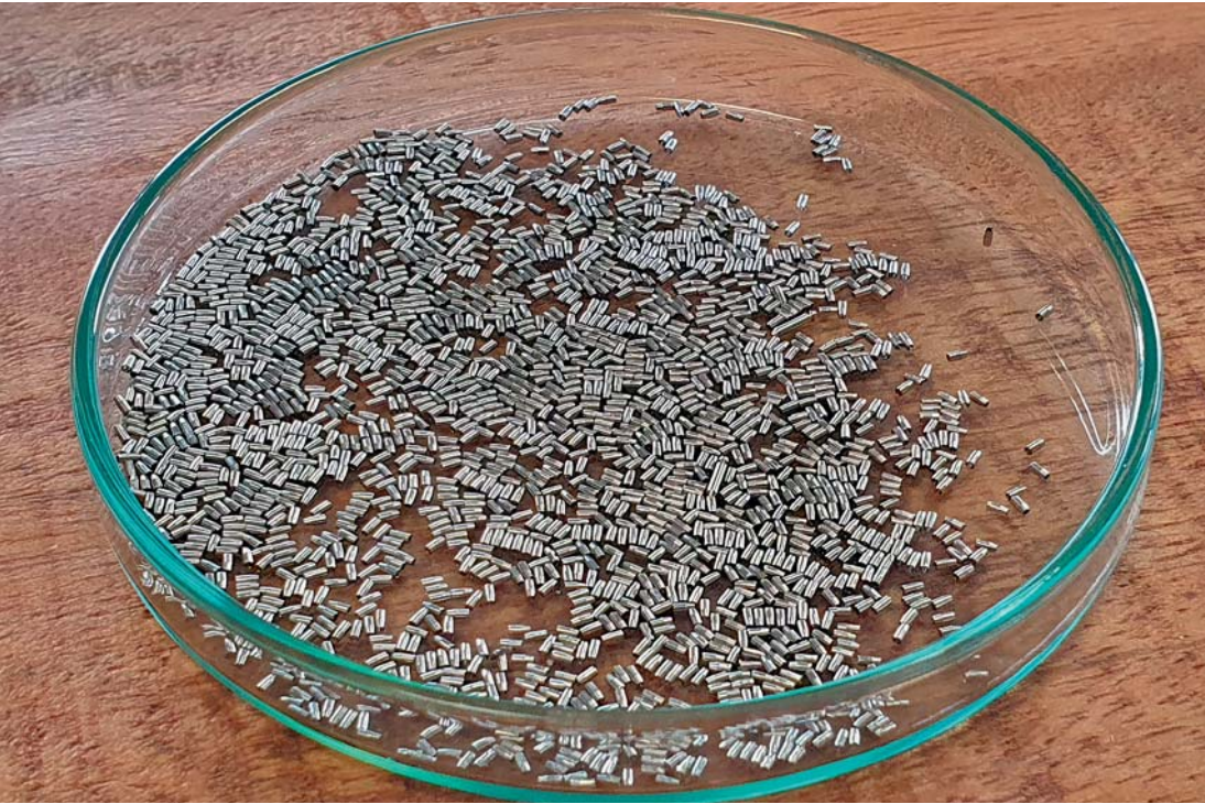
用Tornos机床生产的各种精密机械车削零件。
