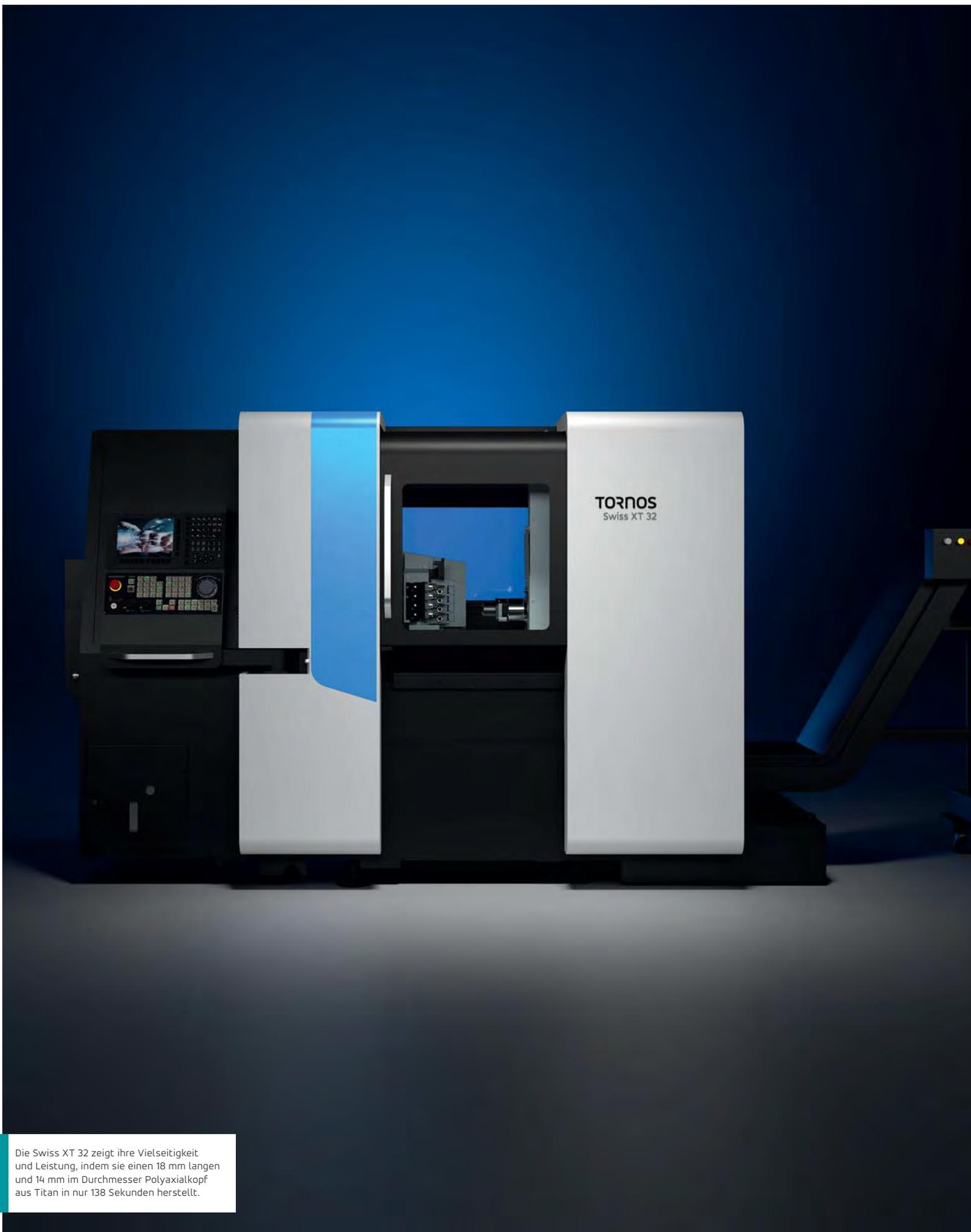
Die Swiss XT 32 zeigt ihre Vielseitigkeit und Leistung, indem sie einen 18 mm langen und 14 mm im Durchmesser Polyaxialkopf aus Titan in nur 138 Sekunden herstellt.
