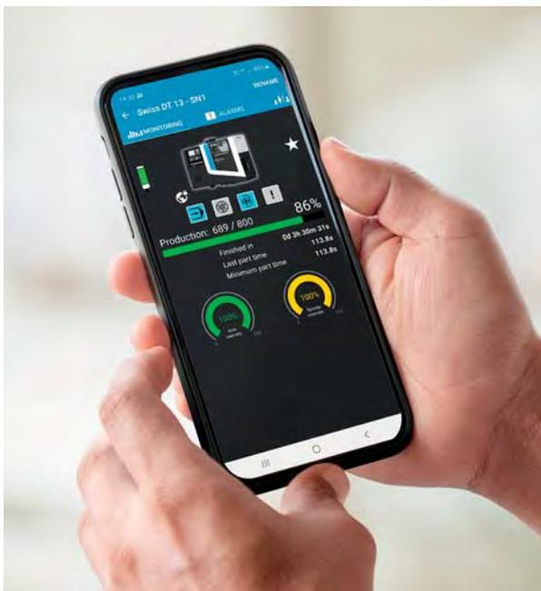
Daten, die auf den Tornos-Maschinen ausgelesen werden können, gehören der aktuelle Maschinenstatus, wie viele Teile des aktuellen Produktionsauftrags bereits produziert wurden, wie viele noch zu produzieren sind und die geschätzte Produktionszeit bis zum Auftragsabschluss.
